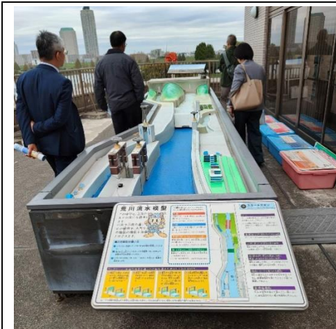
圖 46 隅田川與荒川放水路 分洪模型
