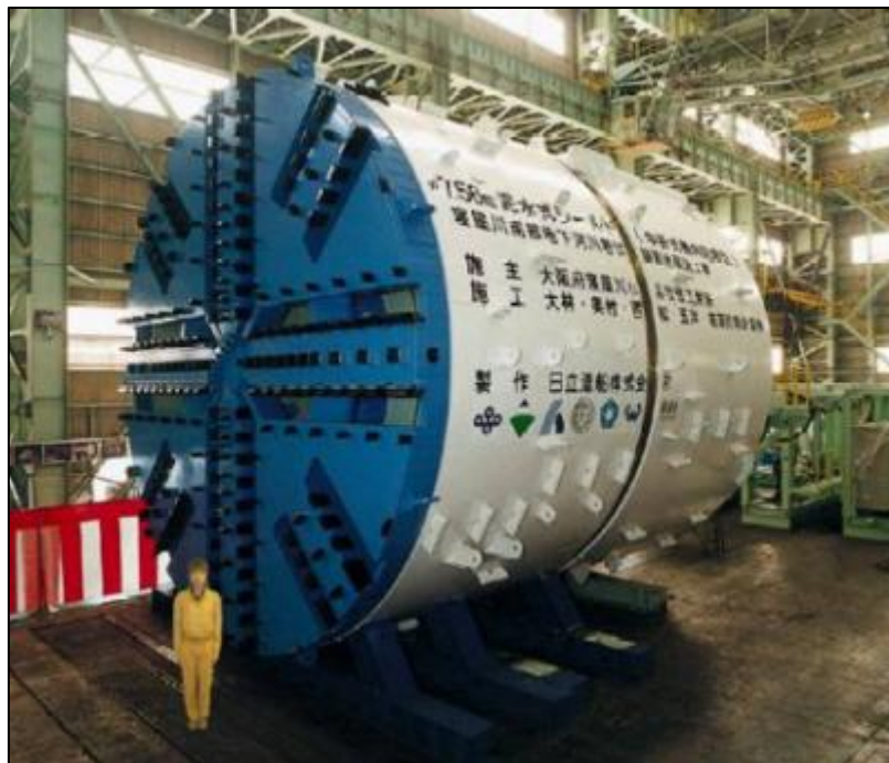
圖 57 美園豎井至若江豎井施工中使用的潛盾機（內徑約 6.9 公尺）
