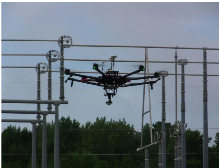
圖表 2：無人機在現場測試中拍攝變電站設備 Resource：EPRI
