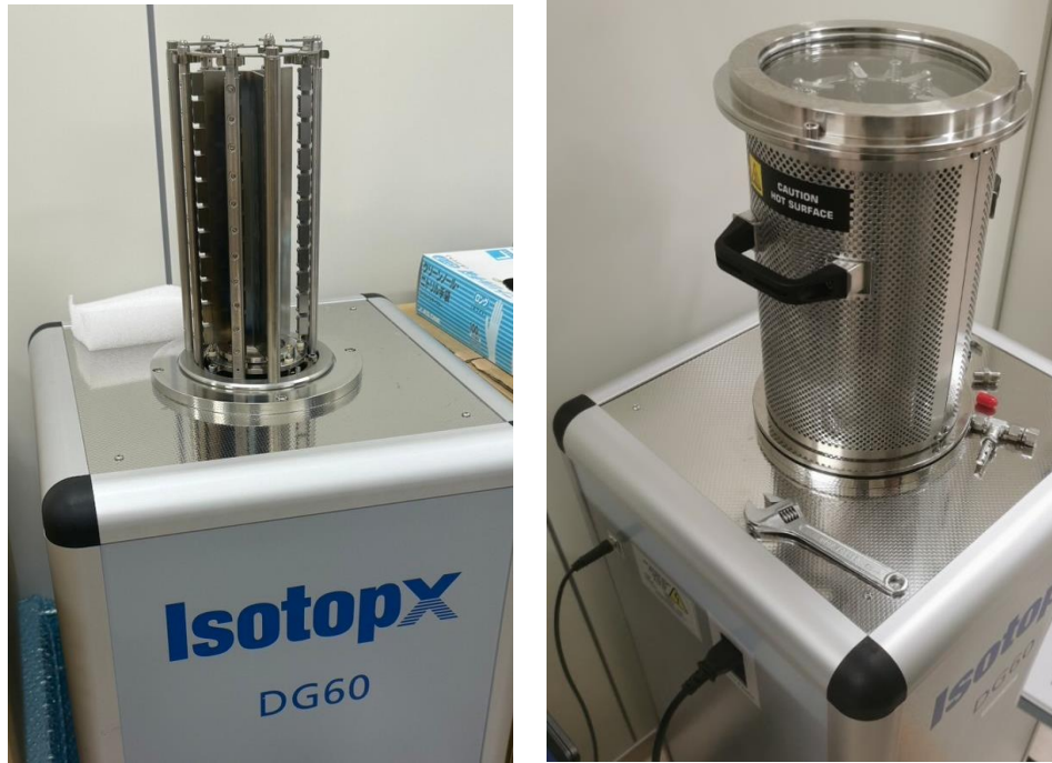
圖 5. 樣品座除汙的設備。樣品座安裝於左圖的架子上，加蓋後如右圖並抽真空。
