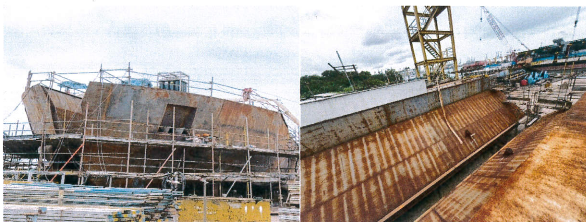
1131218 船艏段 + 泥艙段(船艏段正待組合)
