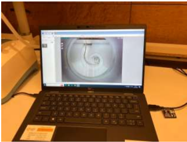
Perimodiolar type 的電極於耳蝸內部的捲曲接觸情形。
