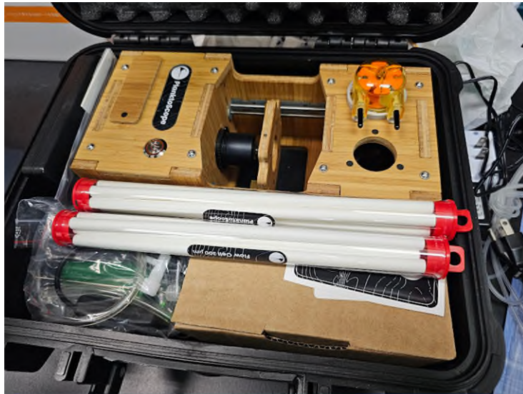
圖 16 具有即時快速拍照功能的流式細胞儀
