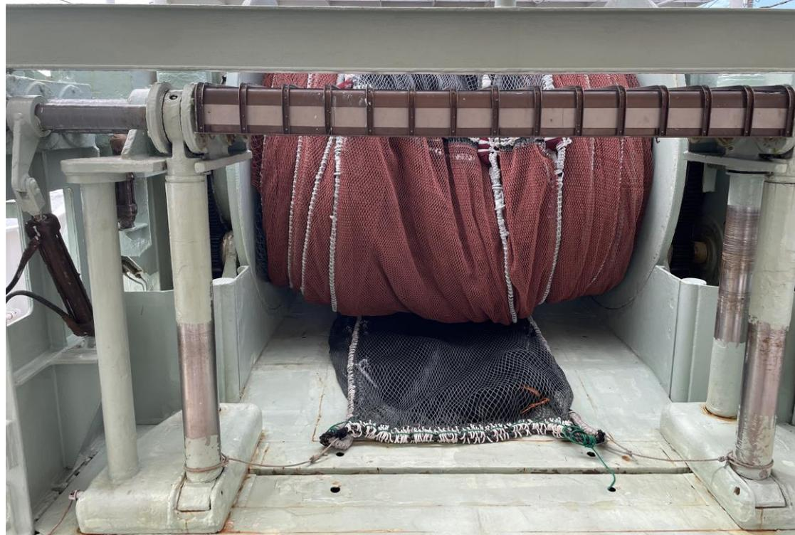
圖十一、立山丸漁業調查船主甲板(上)及拖網設備(下)。
