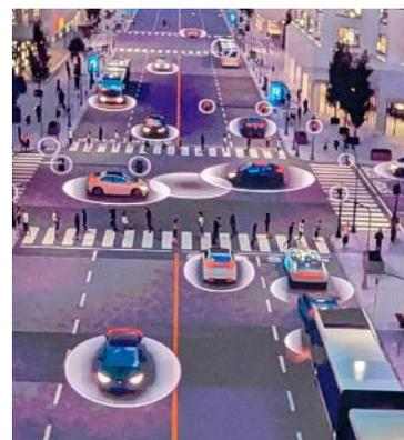
德國高通有限公司歐洲政府事務總監認為弱勢道路使用者 (VRU) 面臨的風險比以往任何時候都更大，故有必要建置特殊運輸設計以支援關鍵交通服務系統，而車聯網 (V2X) 為建置安全駕駛平台的主要關鍵技術，其中包含車輛對基礎設施(V2I)，例如交通號誌時制及優先序；車對車 (V2V) 通訊，例如防撞安全系統；車輛對網路(V2N)，例如即時路況、路線及雲端服務；車輛對行人 (V2P)，例如行人、騎自行車者的安全警示，路口車聯網設施組成詳圖 2-2-7。
