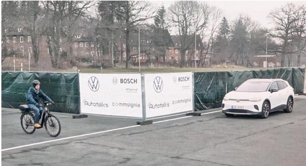
康馬尼亞(Commsignia)利用精簡版車用機組(OBU)支援 V2X 的自行車，其設備包含 Commsignia 自駕車級 V2X 軟體組成的標準且安全自行車之零組件、最先進的定位、未來趨勢介面、適合自行車的車架與行動整合平台。
