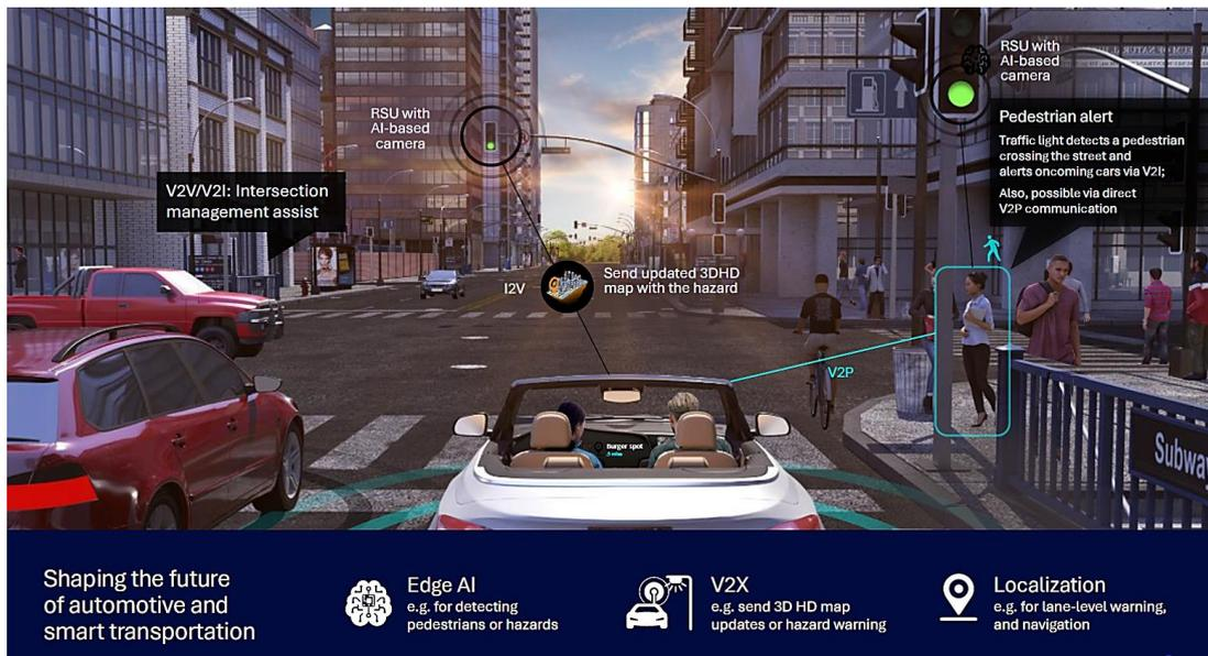
圖 2-2-8 以人工智慧攝影機偵測弱勢道路使用者傳輸至車聯網
