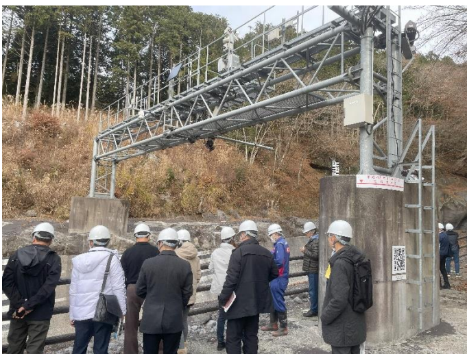
圖 13 上游土石流監測系統
