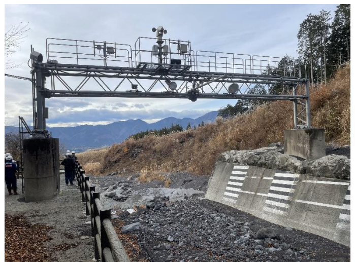
圖 14 上游土石流監測系統
