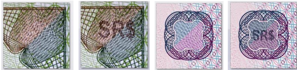
圖 4-15 利用凹版技術印製隱藏字 (資料來源：2025 Intergraf Milan proceedings)
