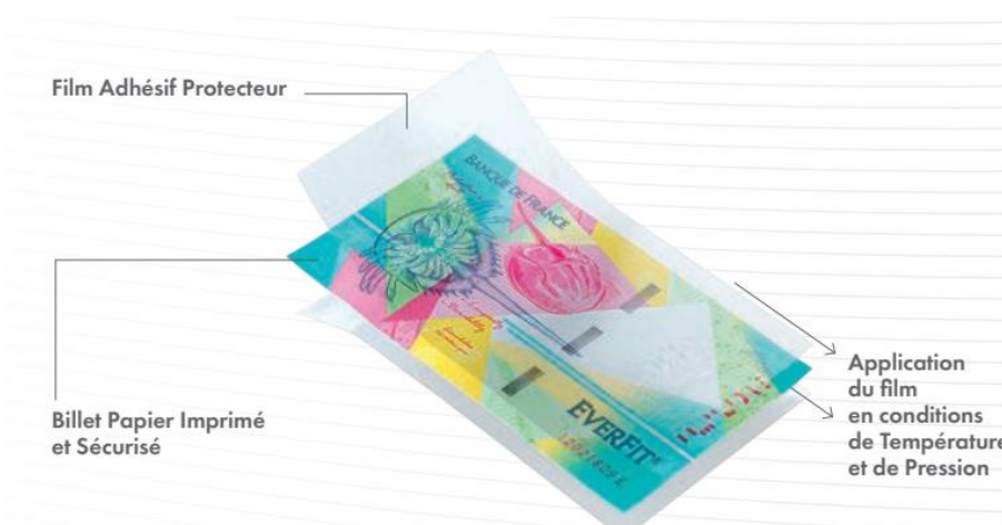
圖 4-30 利用 EverFit®技術於鈔券表面覆蓋聚合物塗層以增加耐流通性 (資料來源：法國中央銀行官方網站 https://www.banque-france.fr/fr )
