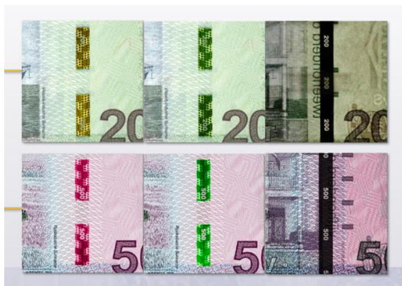
圖 4-11 RollingStar® i+ Cube 動態窗式安全線 (資料來源：2025 Intergraf Milan proceedings)
