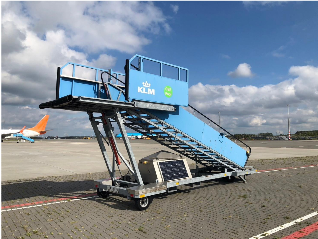
圖 3-28 傳統登機梯附太陽能動力裝置(資料來源：Schiphol 機場)
