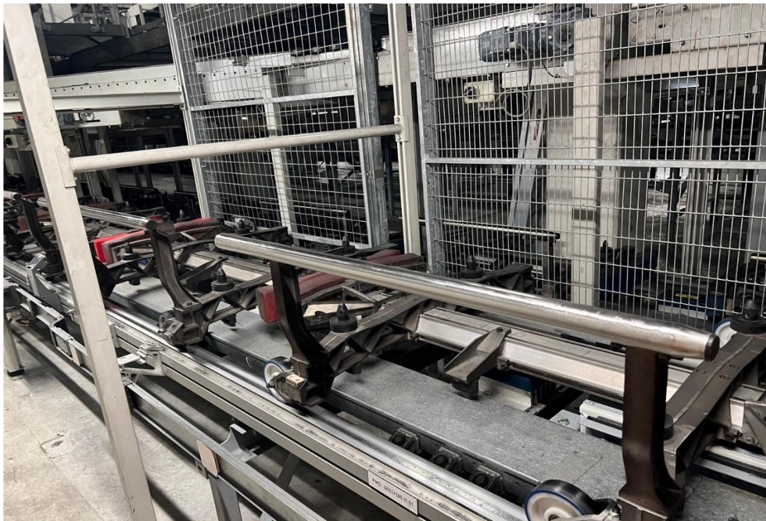
圖 3-15 第一代獨立裝載系統 (資料來源：Schiphol 機場)
