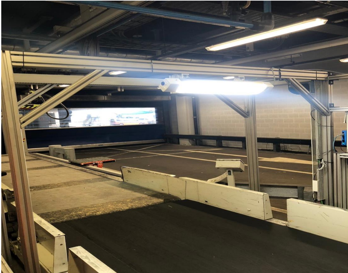
圖 3-13 自動編碼讀取器 ATR (資料來源：Schiphol 機場)
