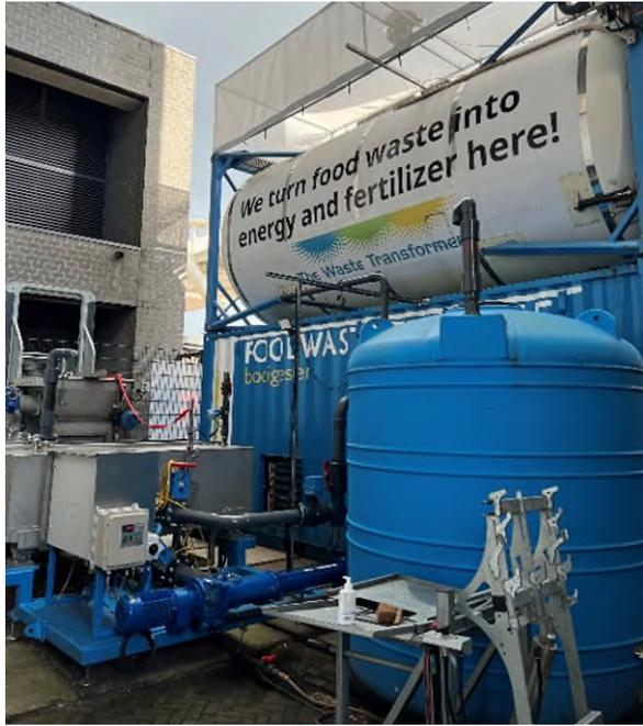
圖 6、The Waste Transformers 公司所採用的處理剩食機器
