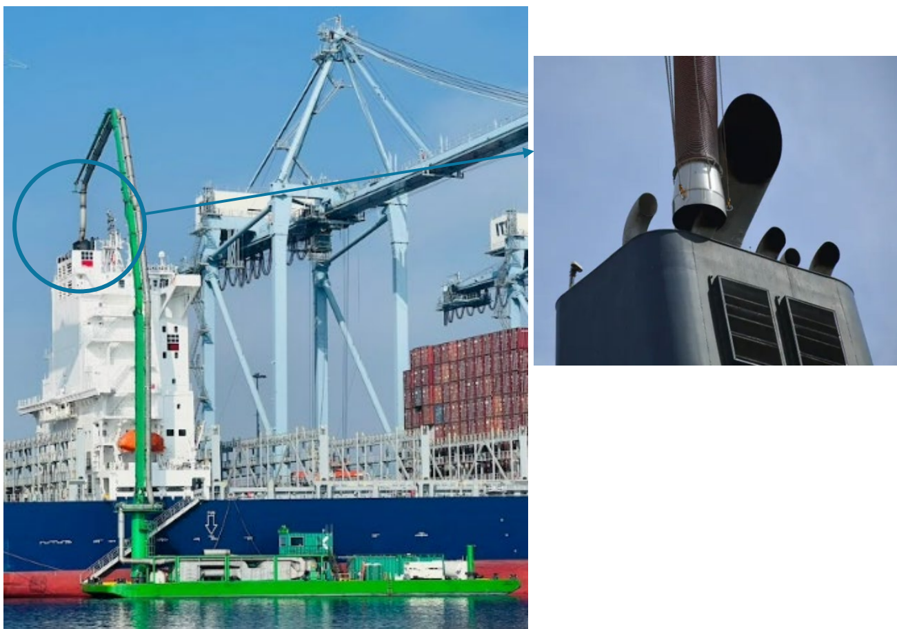
圖 8、船舶煙囪廢氣處理示意圖
