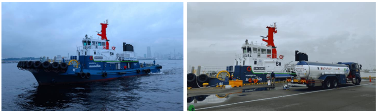
圖 31-氨燃料拖船，以及以槽車運送方式加注氨燃料
