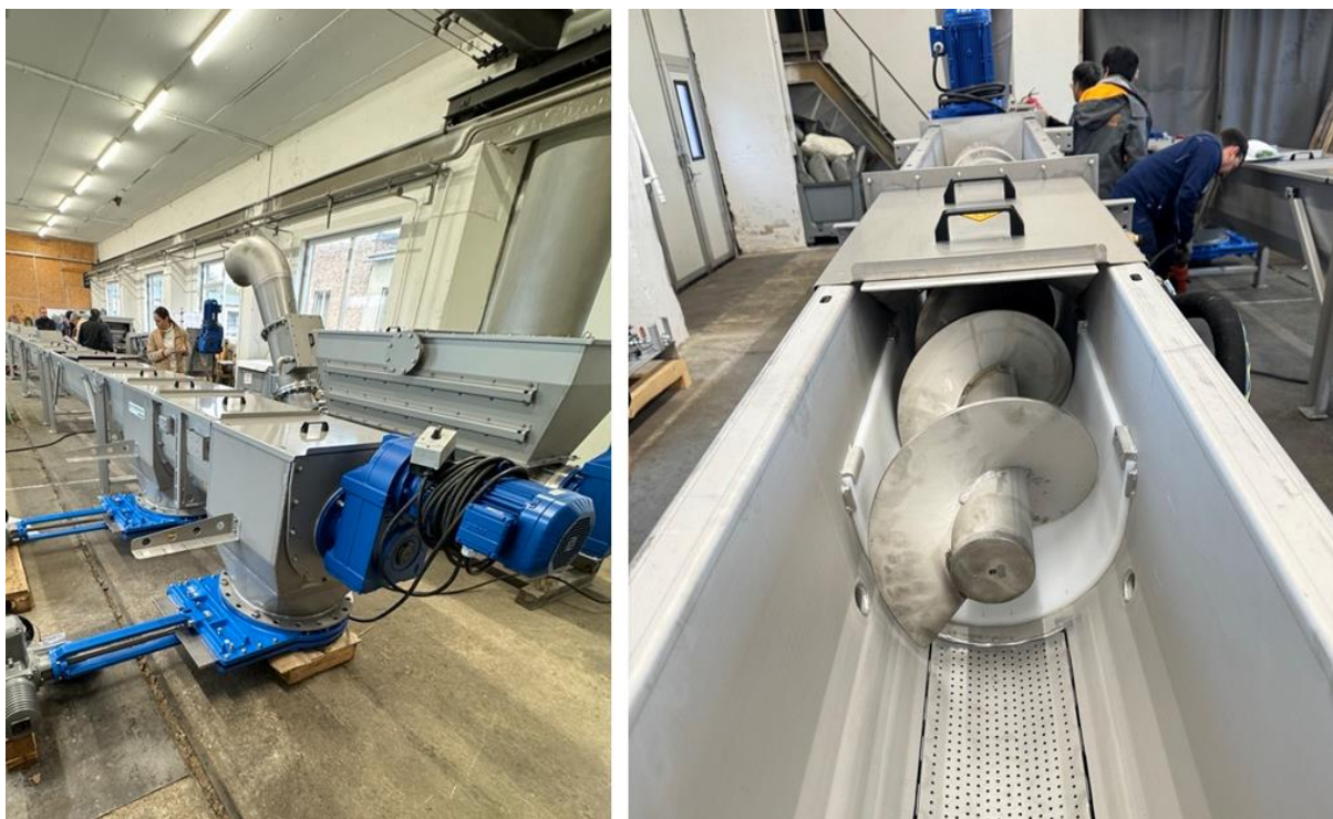
圖 2-9 螺旋輸送機外觀/內部構造
