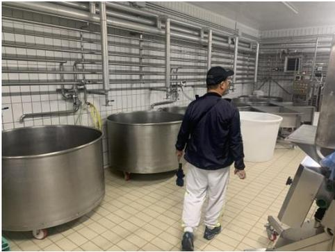
圖 5. 凝乳用的不鏽鋼槽。
