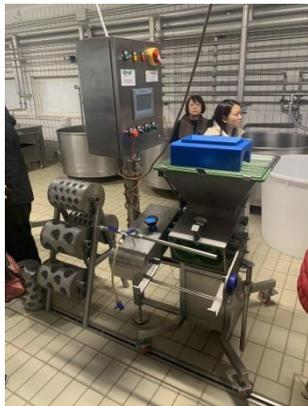
圖 7. 莫札瑞拉起司之機器塑形設備及其金屬模具。
