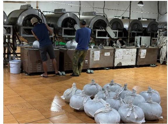
圖十二、製茶工廠內的束包機
