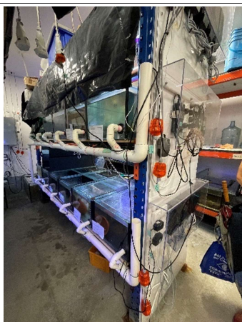
圖 8-13 同一排缸子共用同一組過濾系統
