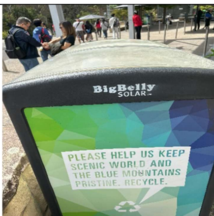
圖 1-29 太陽能垃圾，用太陽能將垃圾自動壓縮節省人力收集次數。
