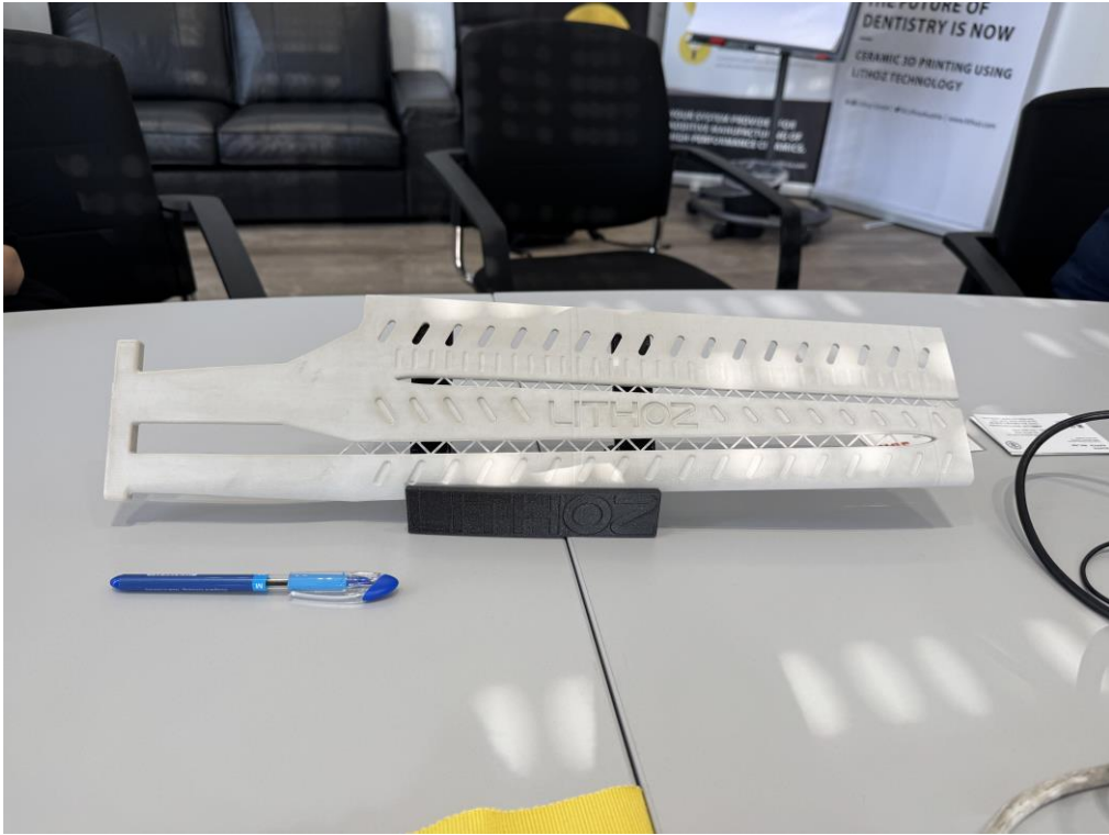
圖 29 氣渦輪機葉片陶芯成品
