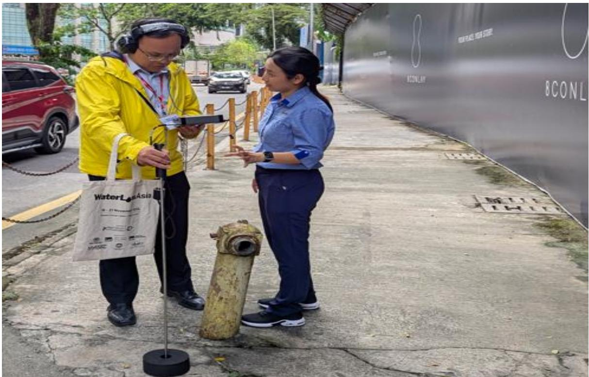
圖 49 使用 MIKRON3 JUNIOR 電子式聽音設備檢測地下漏水
