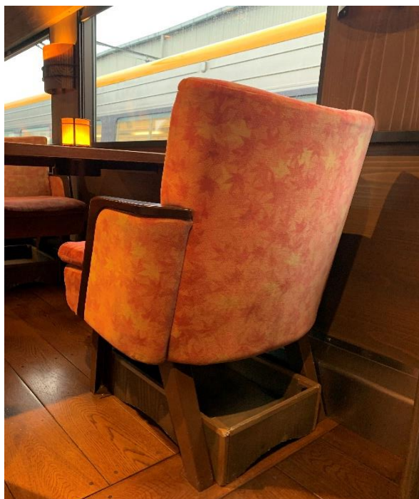
圖 88 固定式座位配置可快速更換之座椅坐墊
