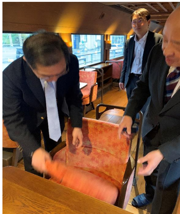
圖 88 固定式座位配置可快速更換之座椅坐墊
