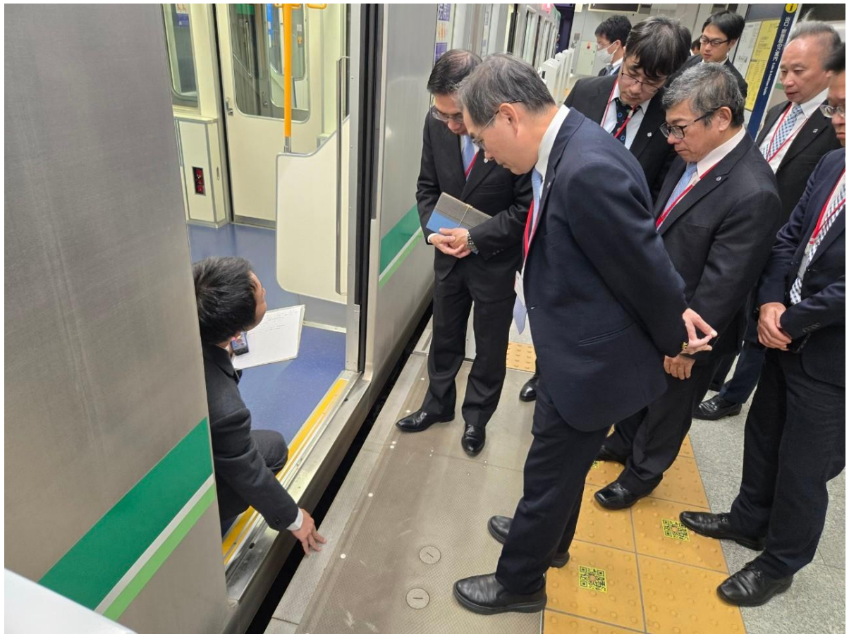
圖 120 模擬月台訓練空間之月台設置月台縫自動閉合之安全裝置
