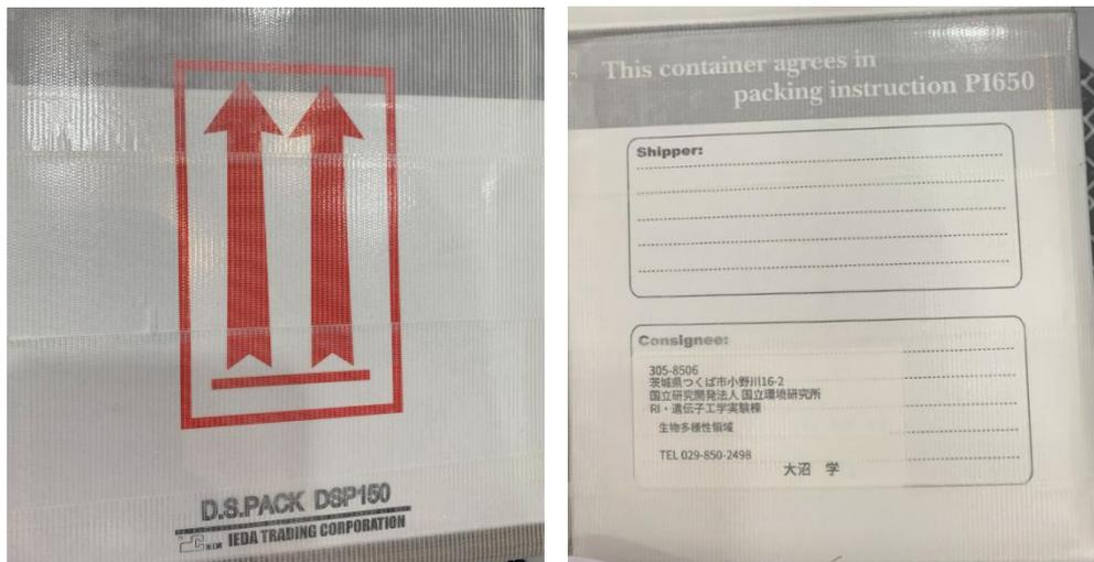
圖七、包裝外層標示箭頭，表示內有液體，告知人員正確處理方向，避免滲漏，並外包裝須註明依據 PI650包裝指令、運輸人及收貨人資訊。
