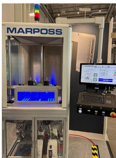
圖 18 Marposs 氫氣偵測洩漏裝置
