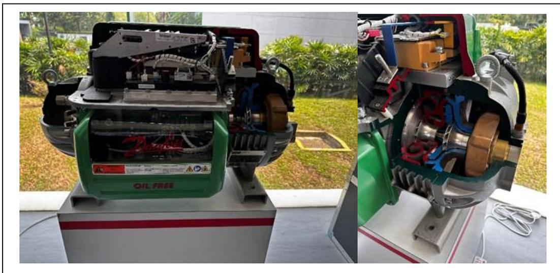
圖 8：磁浮離心式空壓機
