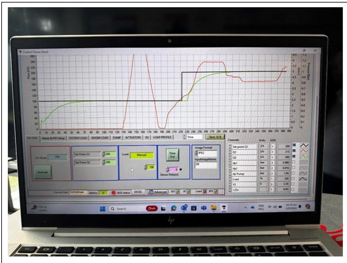
圖 6：Danfoss 整體系統穩定時間(綠線)與他廠(紅線)比較
