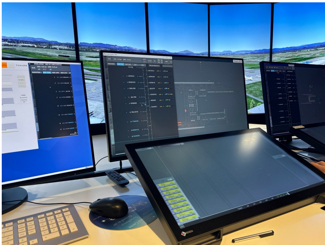
圖 25 離到場管理系統與 A-SMGCS 視窗可互相切換
