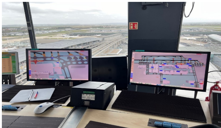
圖 8 每個席位皆配置 2 個 A-SMGCS 顯示器
