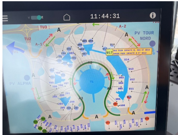
圖 9 停機坪資訊系統局部放大可清楚顯示停機坪作業提醒
