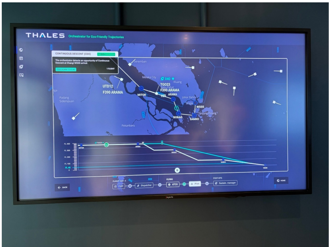
圖 29 Orchestrator (Thales 新流量管理工具)偵測到航機可使用 CDO 程序可能性
