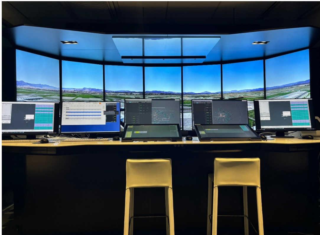
圖 24 Skylab 內的數位塔臺模擬機室
