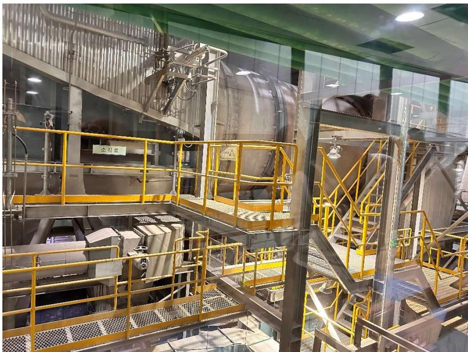
圖 11、焚化底渣旋轉窯燒結爐
