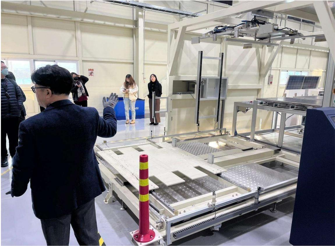
圖 27、廢太陽光電模組回收處理流程-鋁框架拆卸設備
