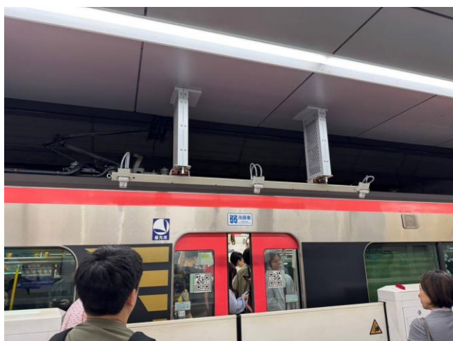
圖 62 列車車門外設置 QR 碼，實現自動識別列車停靠位置
