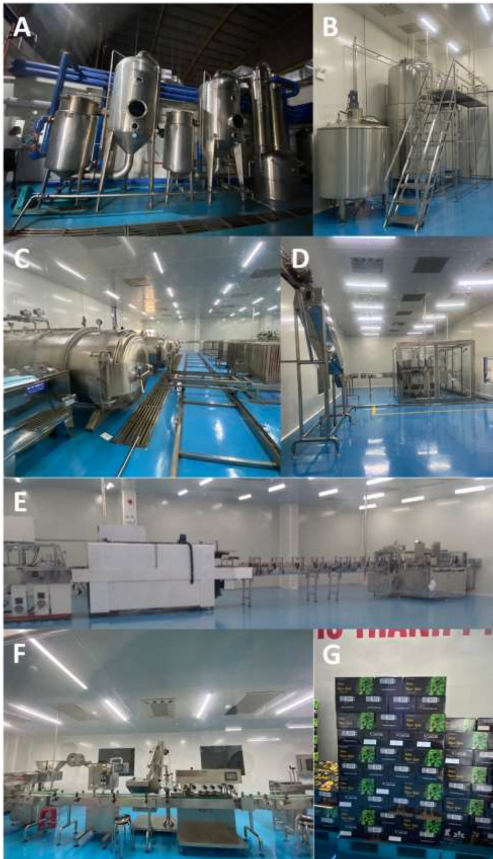
圖九、長生國際科技開發股份有限公司（Công ty TNHH Phát triển khoa học quốc tế Trường Sinh）的藥用食品加工廠。大型萃取槽系統（A），透過玻璃窗觀看無塵室設備：製造室的下游萃取槽系統（B）與滅菌釜（C），填裝室1的裝罐機（D），填裝室2的裝錠機（E），封裝與貼標機（F），商品儲存庫（G）。
