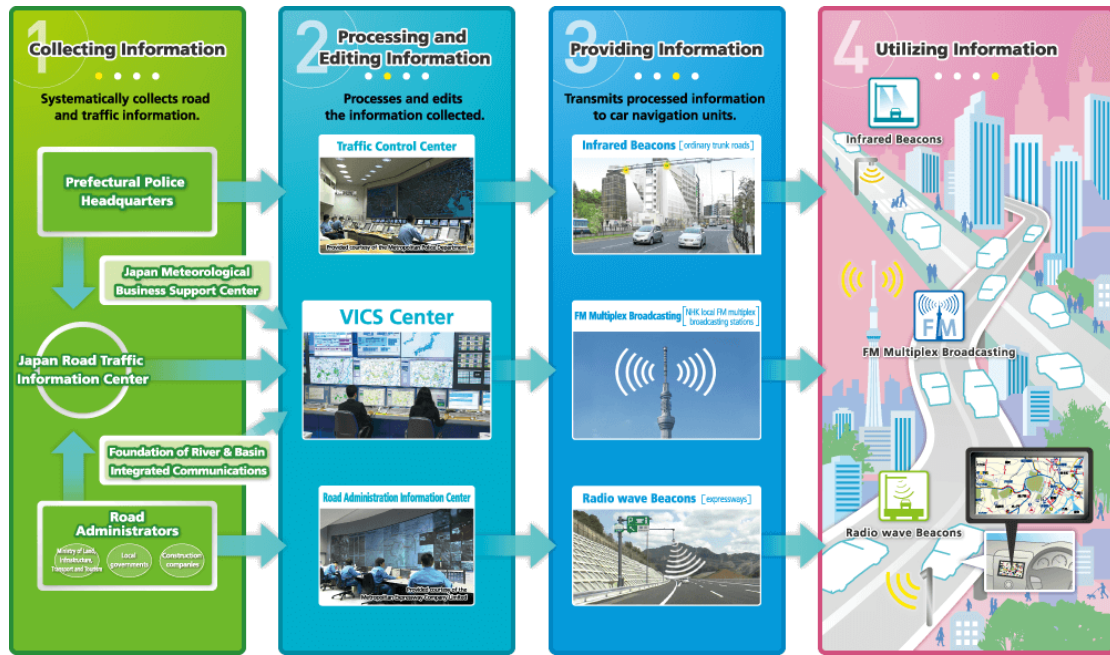
圖 17 VICs 系統資訊處理流程
