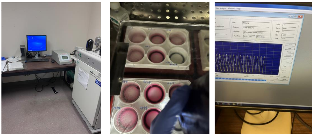
圖七、Flexcell system 為小樑細胞進行週期性伸張（mechanical stretch）的實驗模型，在實驗擺設為伸張機器與特別連接於伸張使用的細胞培養箱。在實驗技術成熟之後，可一次進行 10 個不同細胞株的伸張試驗，在熟稔實驗技術後，一次多個實驗細胞株反而可讓實驗的條件更一致化，更容易達到實驗顯著的結果。
