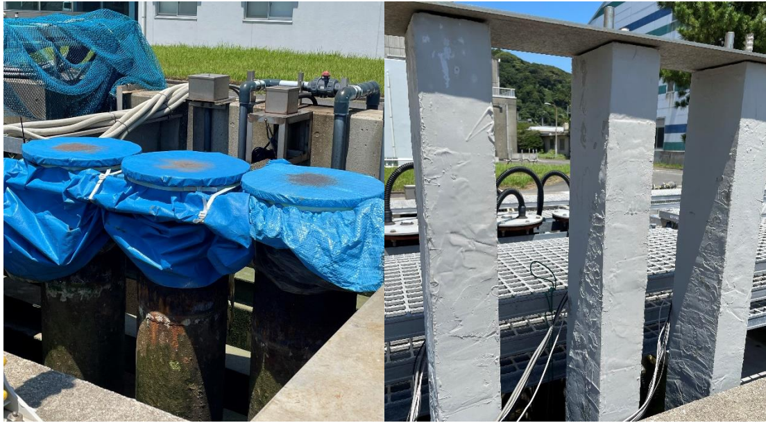
圖 25 長期暴露試驗水槽之鋼管樁腐蝕試驗(左)混凝土材試驗(右)
