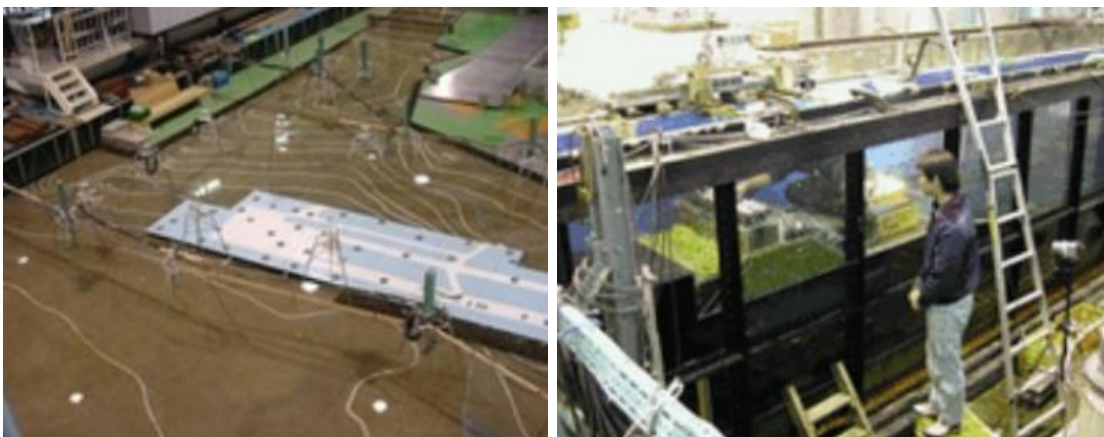
圖 7 大型造波試驗(左)耐波試驗水槽(右)
