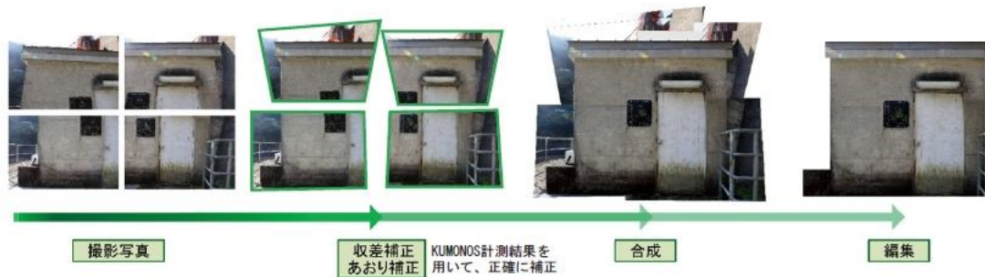
圖 38 使用 KUMONOS 儀器量測及後續進行影像校正、拼貼流程
