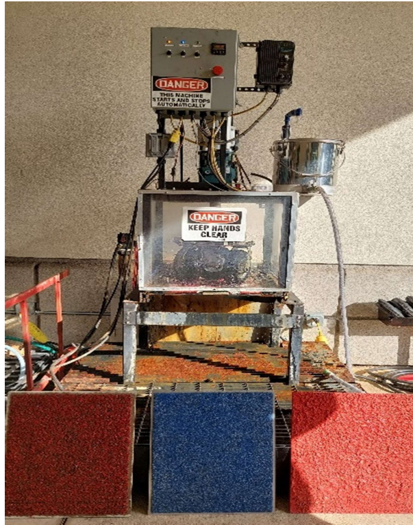
圖 六-2 SMO 室內軌跡輪磨損試驗
