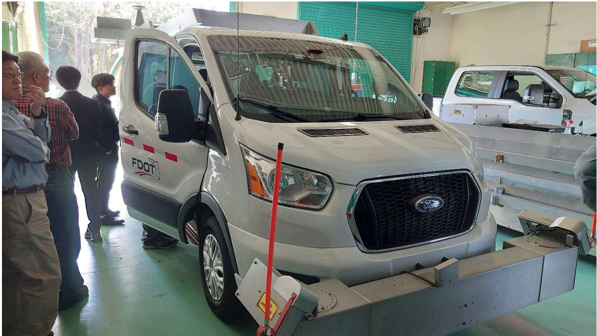
圖 六-10 SMO 鋪面品質現場檢測車 (LCMS) 正面及設備
