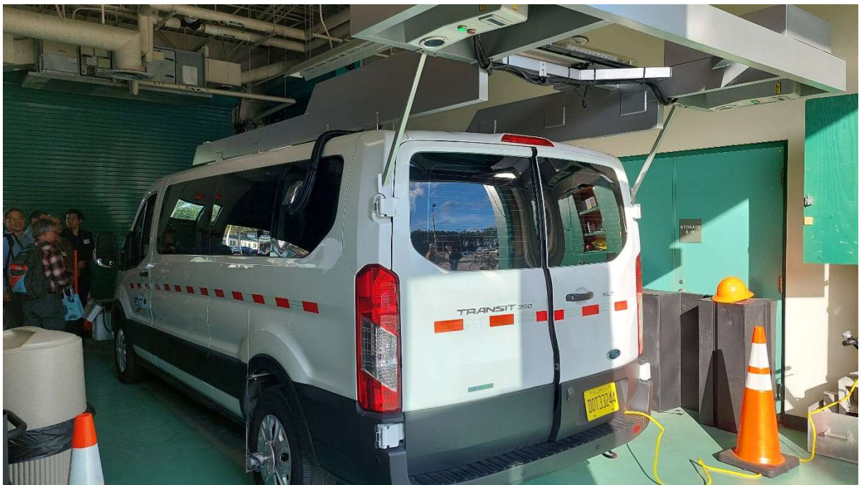
圖 六-11 SMO 鋪面品質現場檢測車 (LCMS) 背面及設備
