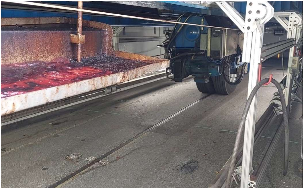
圖 六-9 實尺寸鋪面動態輪磨損試驗機內部
