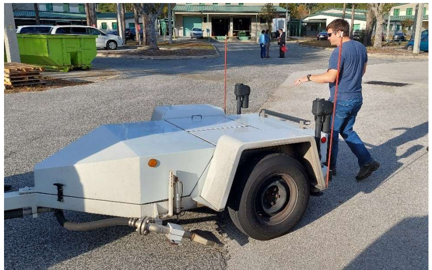
圖 六-12 車載式雷射平坦儀 (IRI)
