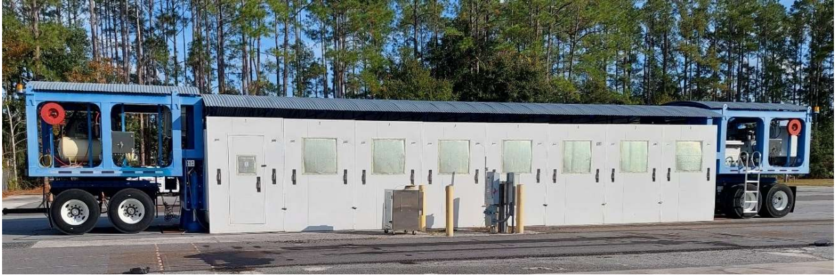
圖 六-8 實尺寸鋪面動態輪磨損試驗機
