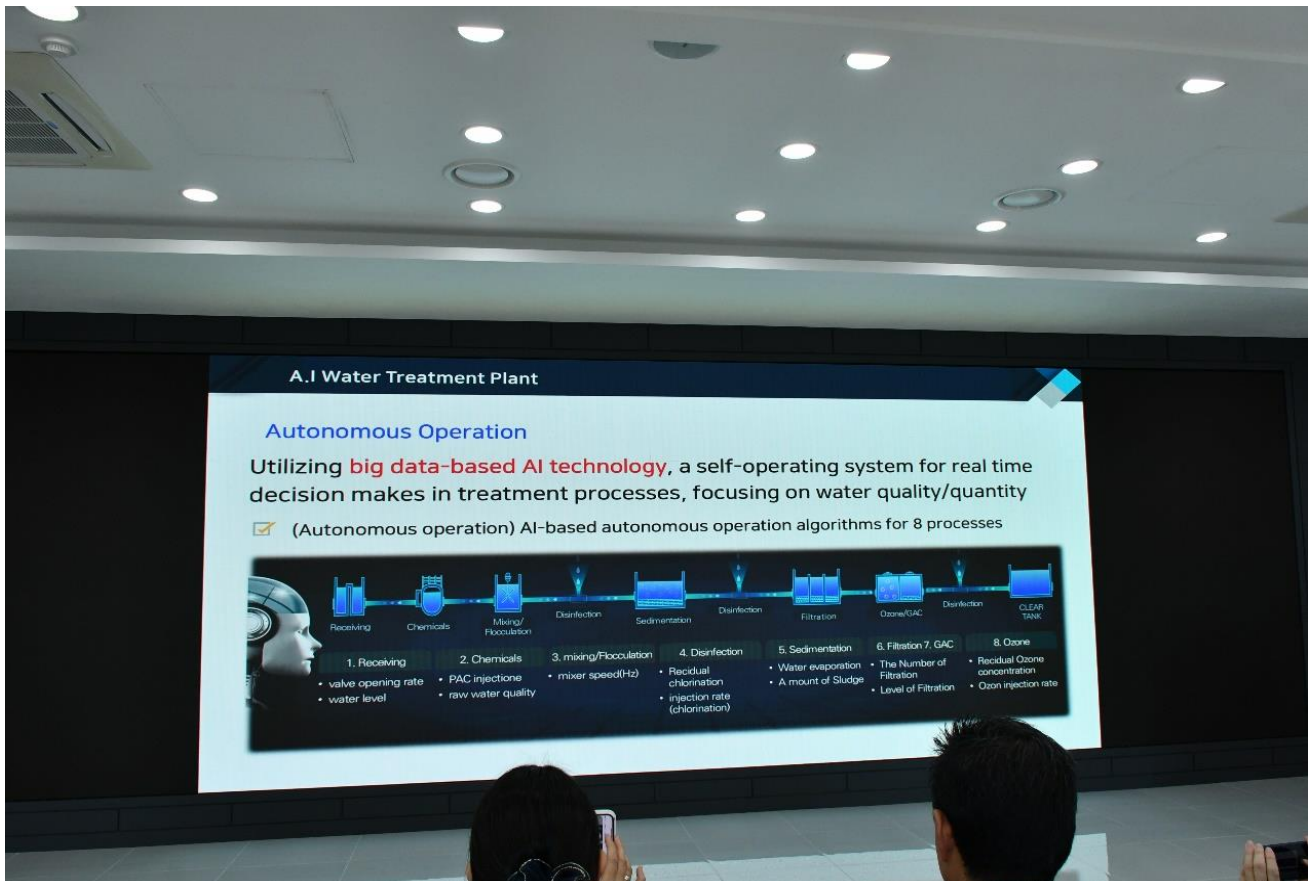
圖 72 華松 AI 淨水場淨水處理流程
