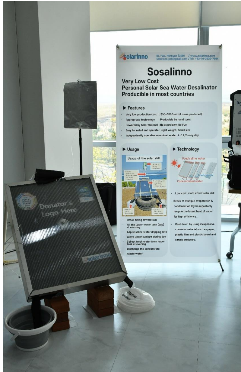
圖 67 微型海水蒸餾器與簡介
