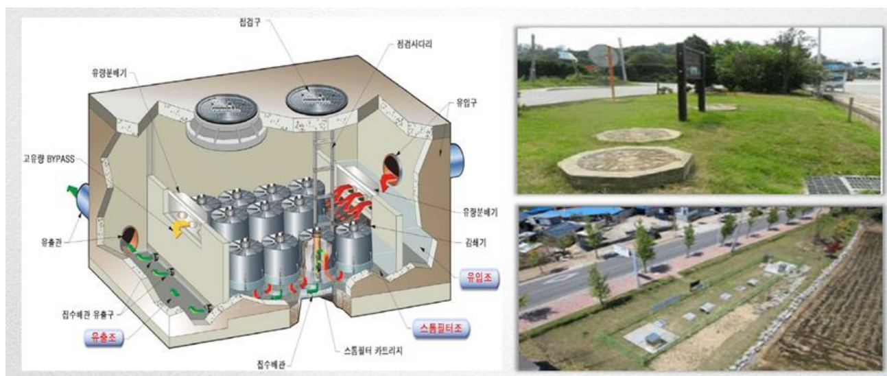
圖10 非點源汙染處理設備
