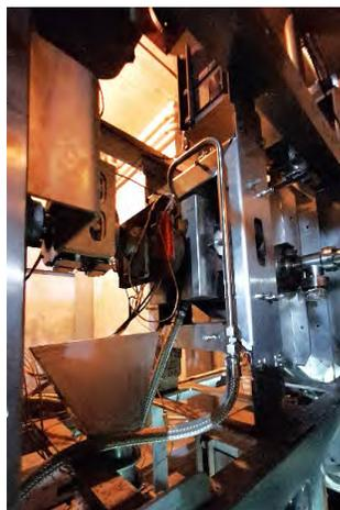
圖 53、X-RAY 輻射照射發射機高壓電場加壓設備
