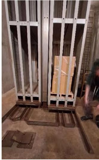
圖 62、專用處理籃及軌道，內側距離發射源 5 公分，外側距離發射源 30 公分
