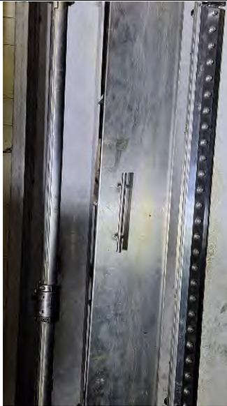
圖 55、電子束擋板 (E-beam stop)
