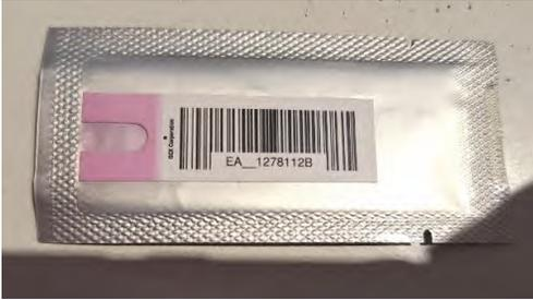
圖 45、變色式薄膜輻射照射劑量檢測片
