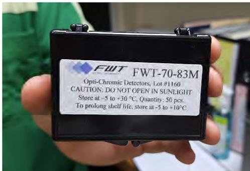
圖 63、低劑量棒型劑量儀(Far West Technology FWT-70-83M)
