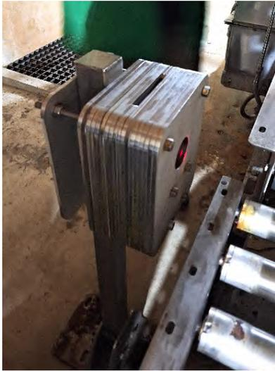
圖 47、電子束發射器
