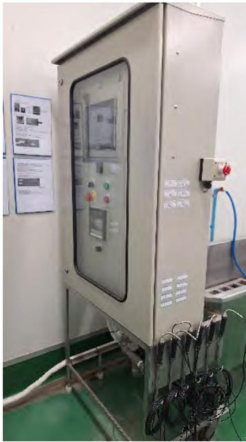
圖 15、溫湯處理溫度計錄器及溫度探針
