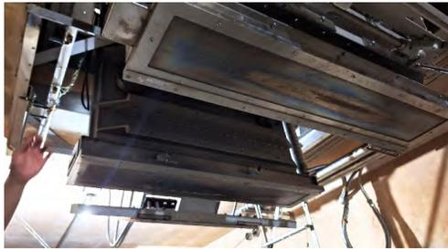
圖 49、電子束電壓加壓裝置，左側功率為 3MeV，右側功率為 10MeV
