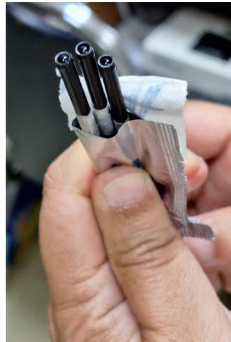
圖 64、低劑量棒型劑量儀(Far West Technology FWT-70-83M)
