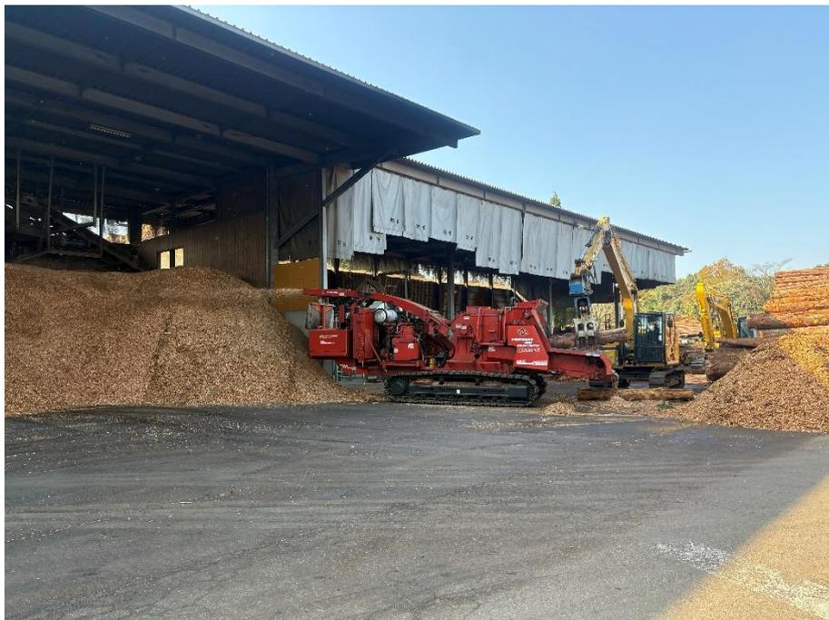
圖 8. 天瀨發電廠生物質運送破碎儲存一貫化系統
