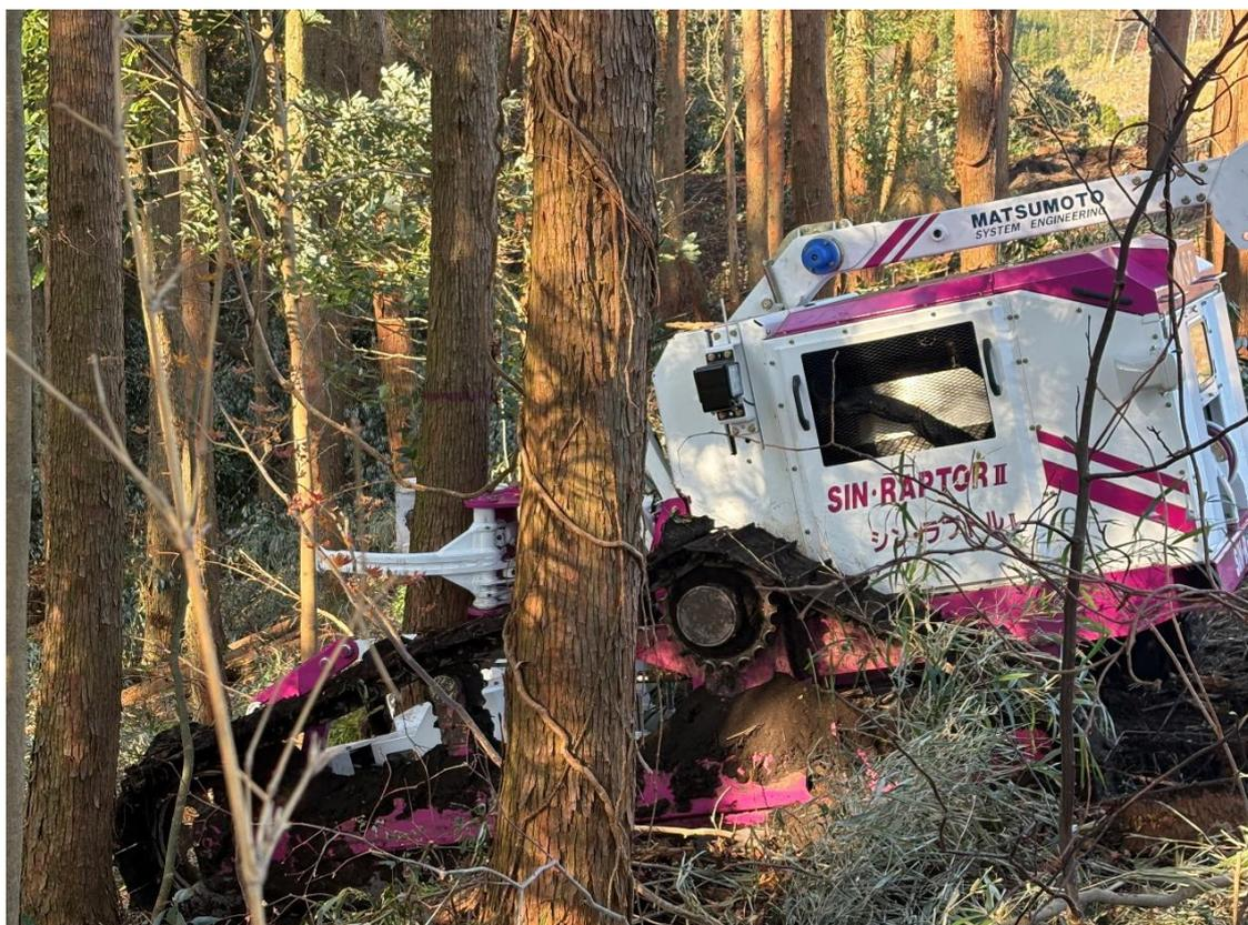
圖 11. 無線遙控生質物收穫車-Shin Raptor 於定向伐倒控制施業
