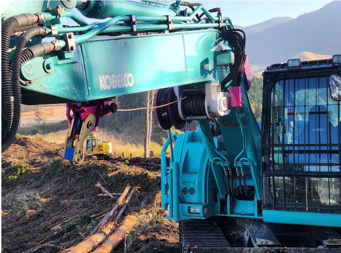
圖 14. 電動絞盤安裝於生物質收穫機增加收穫效率
