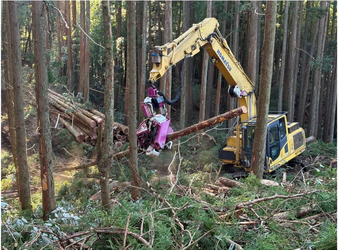
圖 13. 混合滾輪衝程處理器收割機實際操作流程
