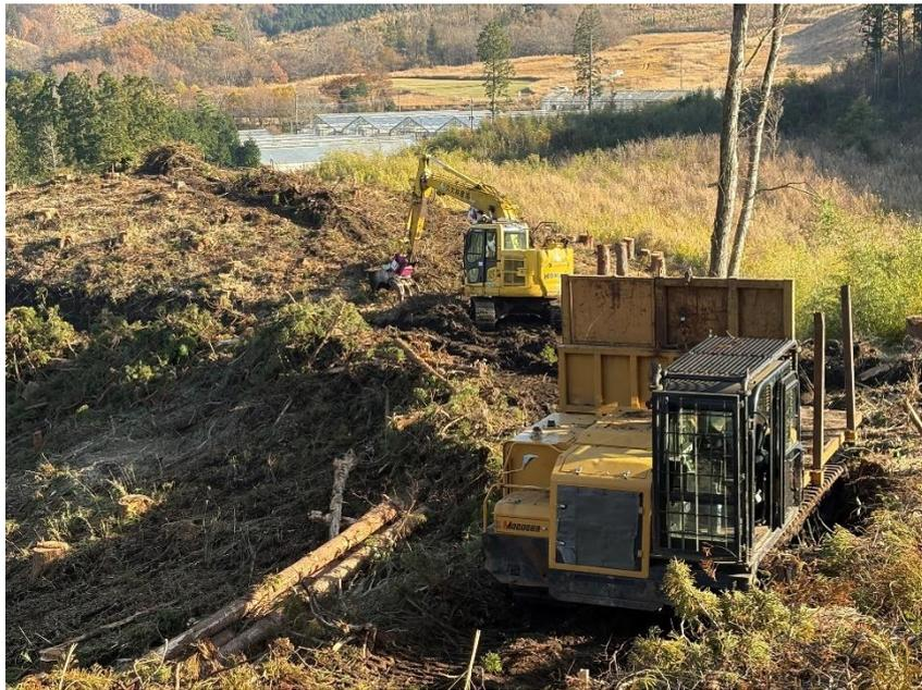
附錄圖 10. 松本系統工程公司的中展示適應各種地形之履帶式生物質運送車
