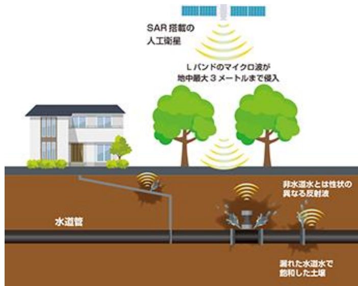
圖 7 衛星偵測水管洩漏的機制
