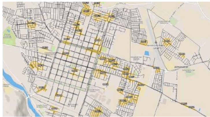
圖 8 分析結果影像（突出顯示可能漏水的管道部分）
