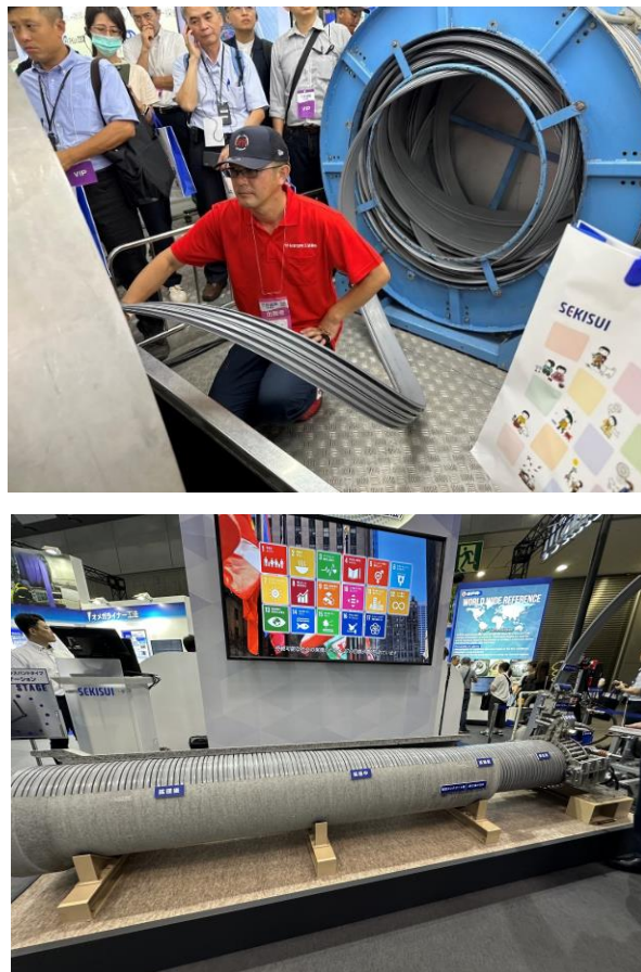
圖 5 積水化學集團與日本 SPR 協會展示管道修復系統特色工法
