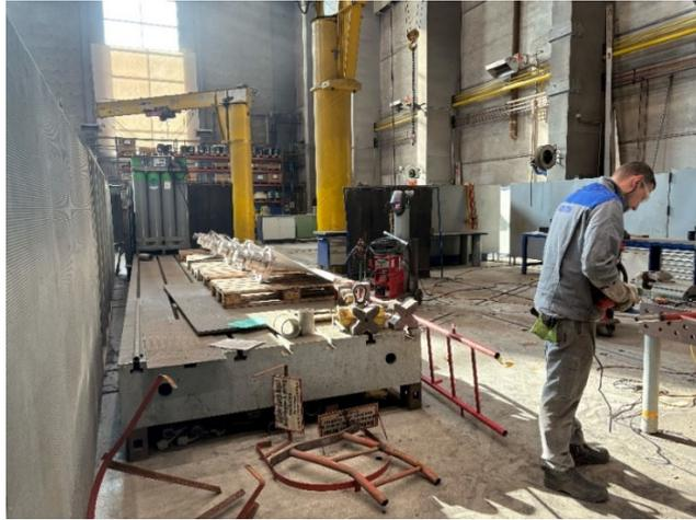
圖 1. 水輪機葉片加工 (Voith Hydro St.Pölten 廠區)
