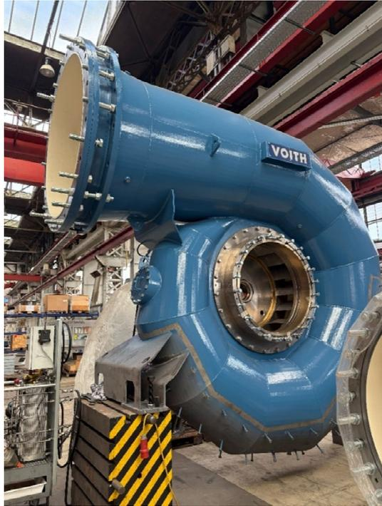
圖 3. 法蘭西斯式小水力水輪機 (Voith Hydro St.Pölten 廠區)
