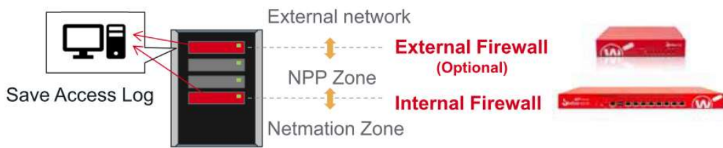
圖 21.NPP+防火牆架構圖
