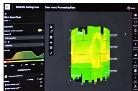
圖 14 儲槽檢測數據
