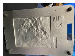
圖 19 管路腐蝕模擬規塊
