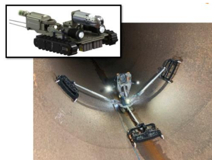
圖 39 壓力管路檢測模式
