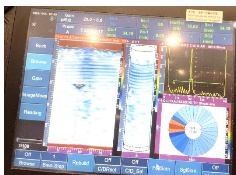
圖 25 TFM 螺栓檢測
