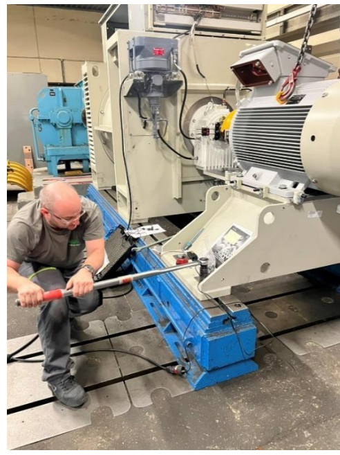
工程師使用扭力扳手進行精密調整
