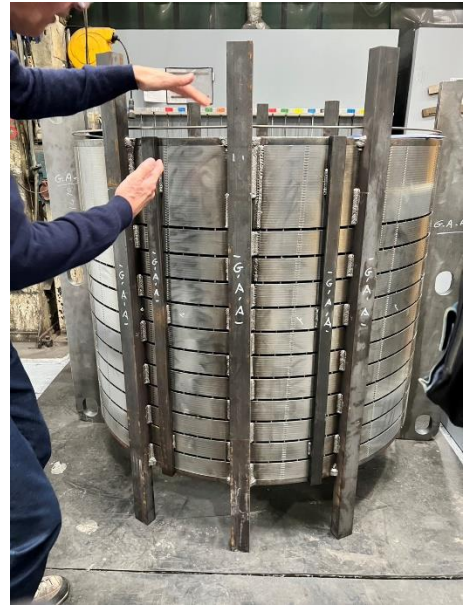
薄鋼片疊壓而成發電機定子鐵芯
