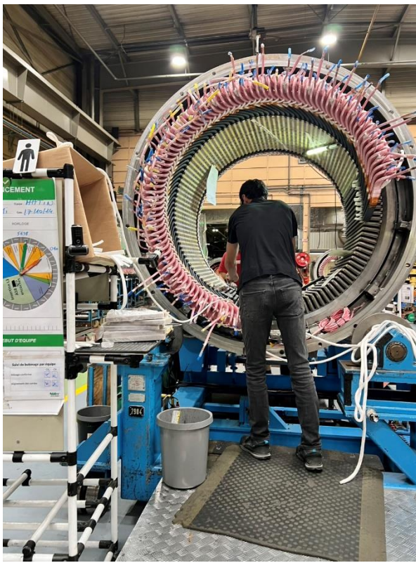
工作人員進行定子繞線作業
