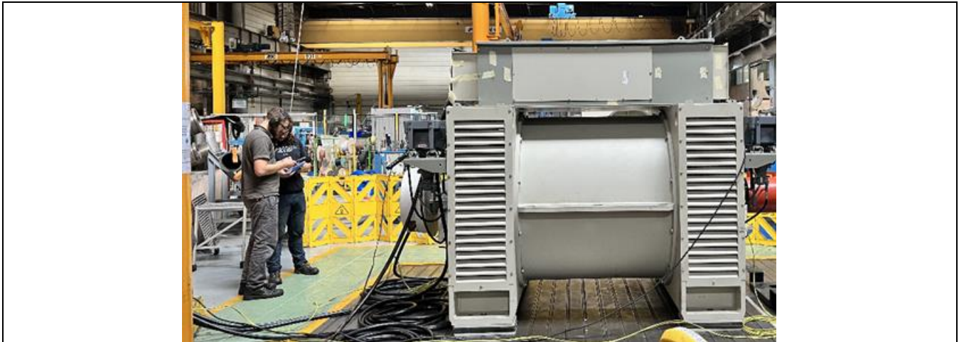
於機器四個面向的不同位置進行噪音測試
