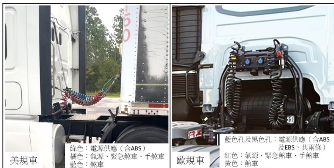
圖2.5-2 美規與歐規曳引車之半拖車連接線組比對圖
