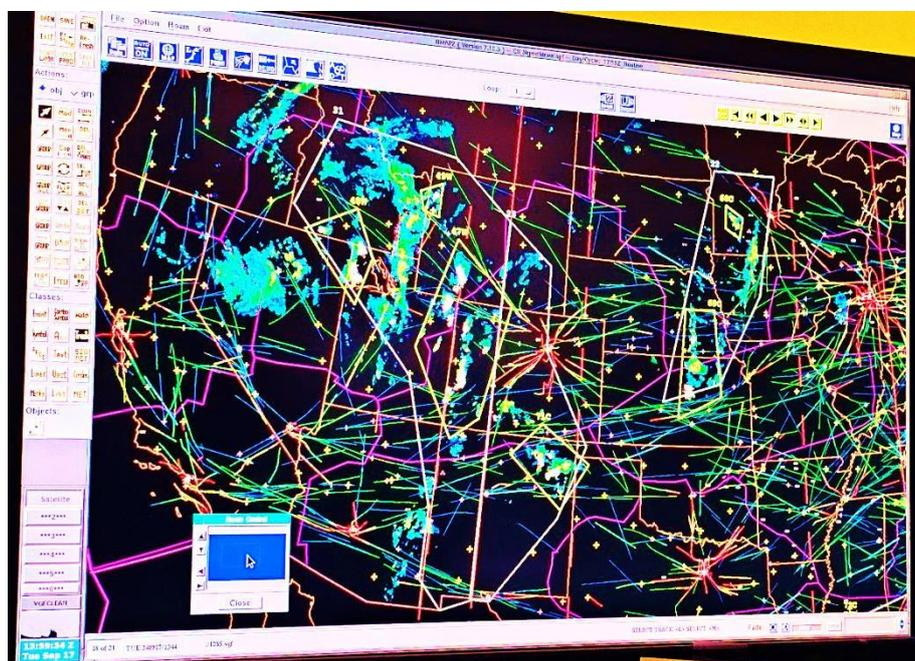
圖 6 整合顯示系統顯示的航機路徑與高度資料，顏色表示高度(紅色高度低，藍色高度高)。此產品不會顯示航機的詳細資料，僅顯示短時間內的路徑與高度。
