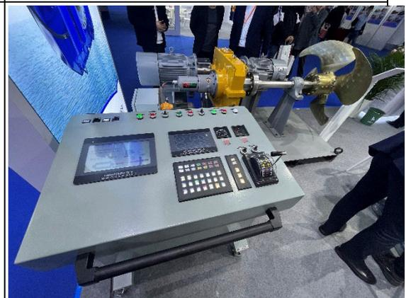
可變螺距系統結合電動馬達推進系統
