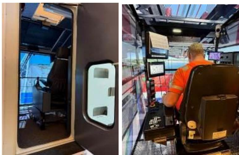
圖 13 起重機駕駛模擬訓練機(左)、橋式起重機駕駛模擬訓練機(右)
