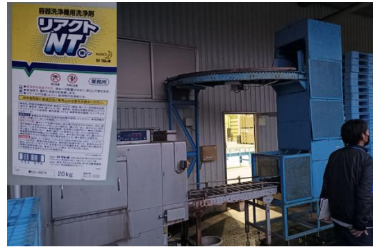
集運籃清洗設備及專用洗淨劑(洗滌劑洗滌+漂洗-蒸氣溫度最高 80°C)。
