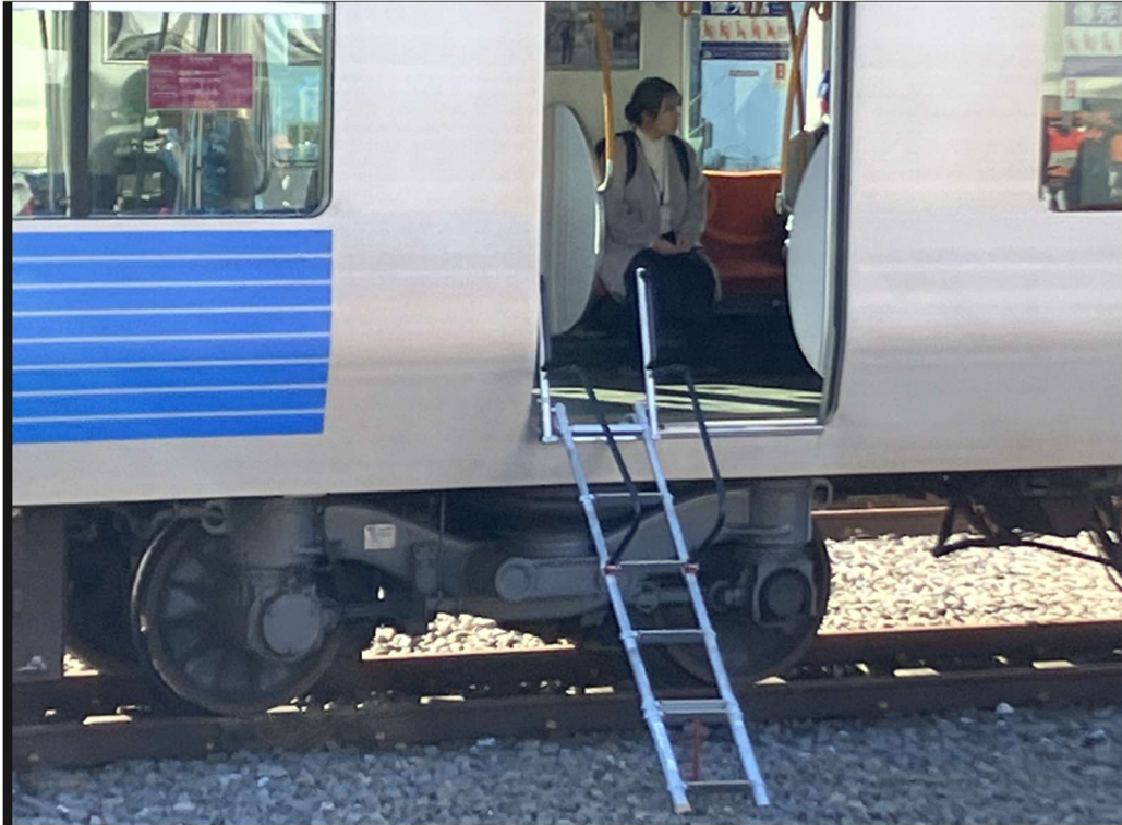
圖 9 接駁梯架設疏散
