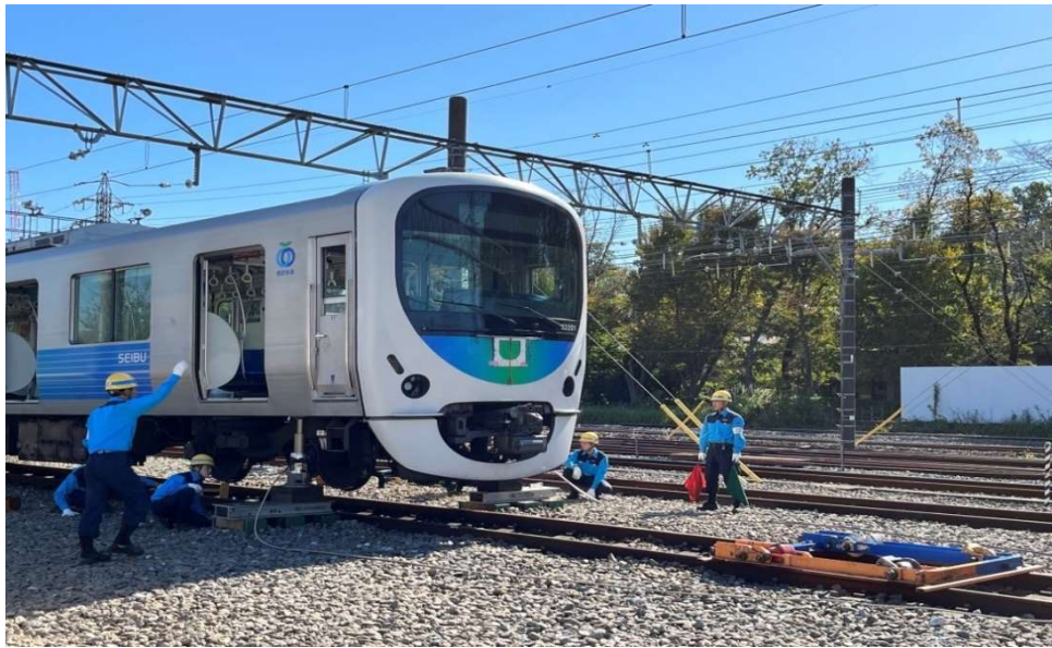
圖 16 使用油壓千斤頂(NDF)將出軌車輛頂起
