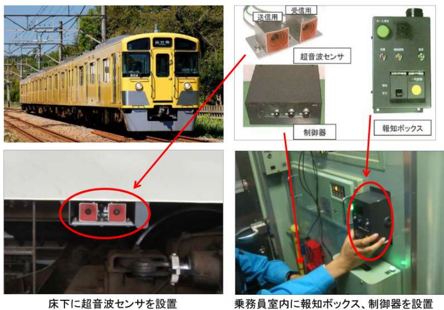
圖 54 多摩湖線車輛防止誤開車門裝置
