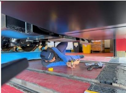
圖 2-14-8 感應子高度量測
