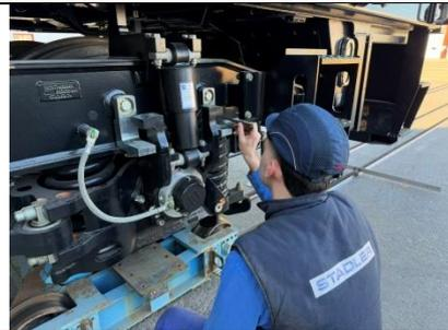
圖 2-14-9 轉向架間隙量測
