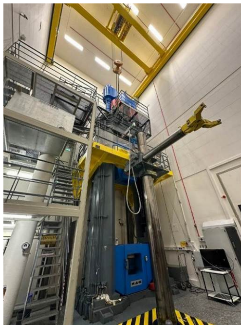
圖 33. 16.5 MN 油壓式力量標準機
