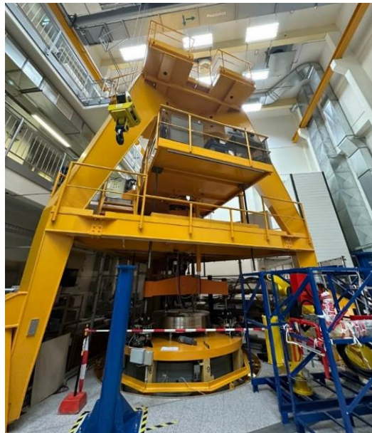
圖 32 2 MN 靜法碼力量標準機及操作系統
