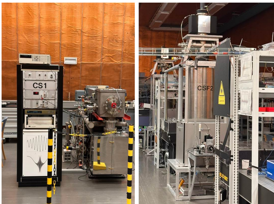
圖 21 德國 PTB 傳統銫鐘(CS)與噴泉式銫鐘(CSF)
