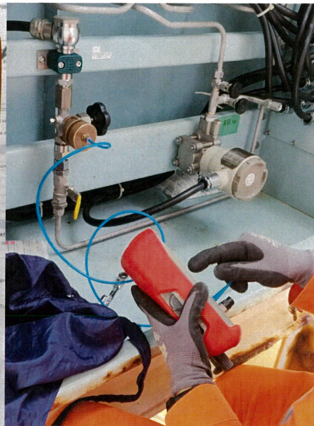
圖六 壓力傳感器校正過程
