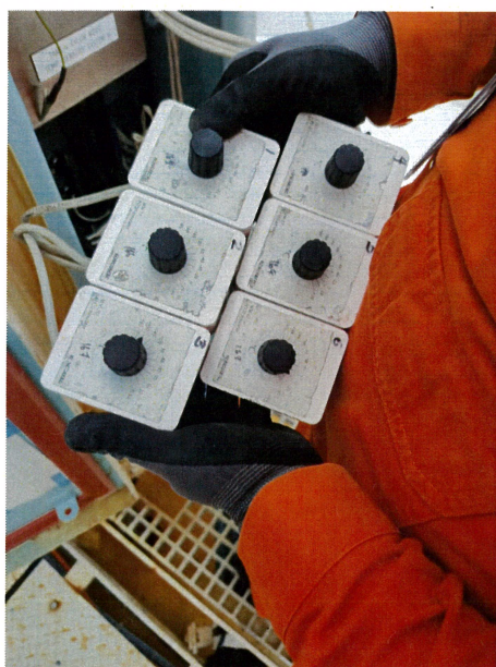
圖三 校正所使用的電阻模擬器 WM-27 外觀，其中一組為備用模擬器
