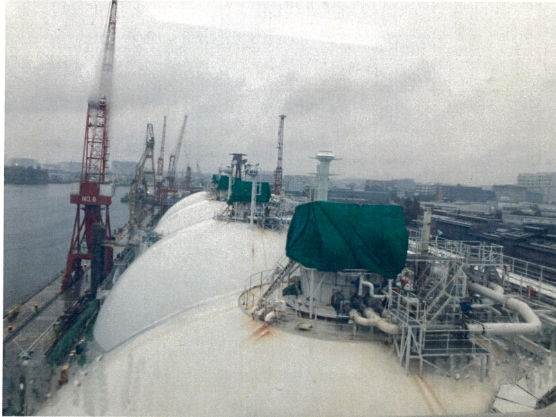
圖十二 於貨倉頂部架設的帆布棚，可發揮保護電子設備與防止貨艙進水的作用。
