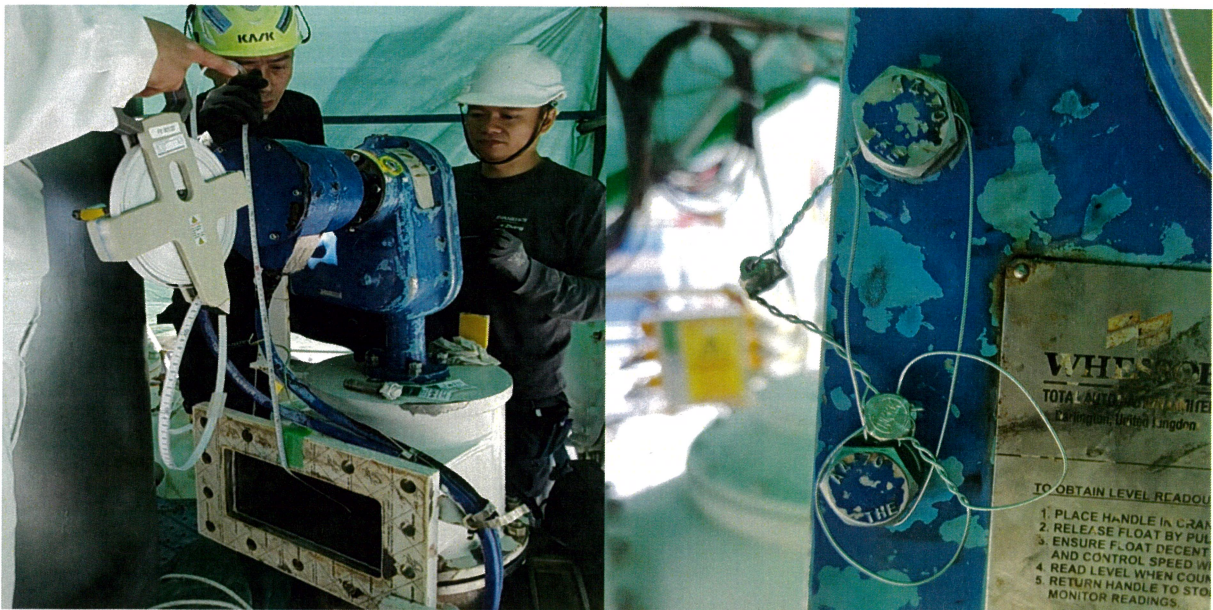
圖一 使用捲尺校正浮球式液位計之過程。
