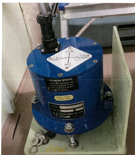
圖七 傾斜儀外觀，可注意到其頂部標示的船體方向
