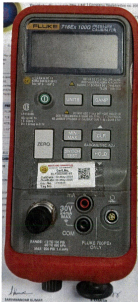
圖五 校正所使用的 的壓力校正器 718EX
